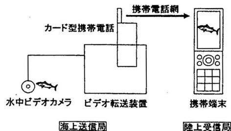
海上送信局では海中ビデオカメラで撮影された映像がビデオ転送装置に入力され、カード型携帯電話から携帯電話網を経由して陸上受信局の携帯端末に転送されるシステムになっています。水中の映像を受信したいときは陸上の携帯端末から海上送信局のカード型携帯電話へテレビ電話をかけることにより開始され、テレビ電話を切れば終了します。また、携帯端末で受信した映像を大型のモニターで観たり、録画することもできます。因みにこのシステムの心臓部にあたるビデオ転送装置のオープン価格は、著者によると約 11 万円とのこと。
